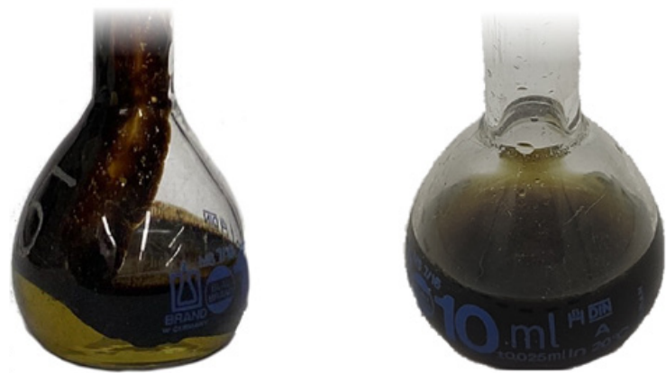
Bild 9: Ölige Kondensate, die aus der Pyrolyse von Kunststoffabfällen im Labormaßstab gewonnen wurden (Quicker & Seitz 2024). Oben: Pyrolyseöl aus einer Mischkunststofffraktion (v.a. PE, PP, PET, PS), Ausbeute 1 % (ein großer Teil der entstandenen Gase konnte mit dem Laboraufbau nicht kondensiert werden). Unten: Pyrolyseöl aus der Fraktion WEEE Kleingeräte/IT, Ausbeute 27,3 %.
