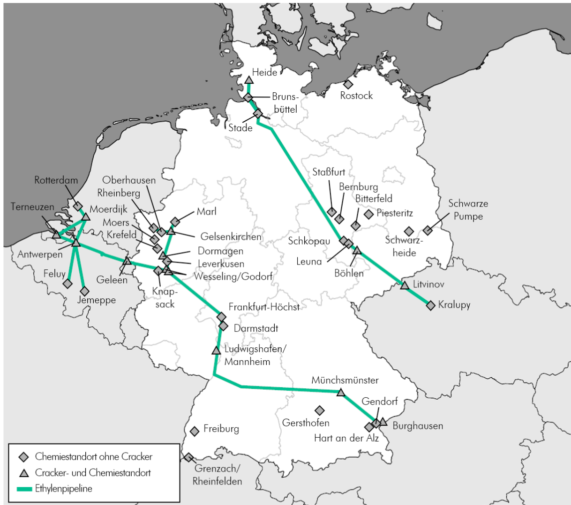
Abbildung 6: Das Distributionsnetzwerk für Ethylen per Pipeline in Deutschland und den angrenzenden Nachbarländern (basierend auf Daten von [40, 80] und Betreiberangaben)
