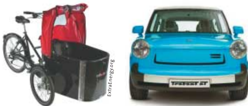
Elektrisch gestütztes Lastenrad und Konzeptauto eines zweckmäßig leichten Elektrowagens (Gewicht ca. 1000 kg) auf Basis des Trabant.
